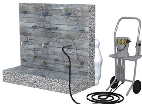
Figura 25 - Injecção de resina acrílica em cortina de impermeabilização [15]
