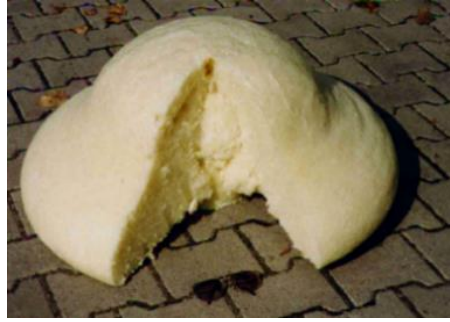
Figura 24 - Resina de espuma de poliuretano após expansão (sem confinamento) [35]
