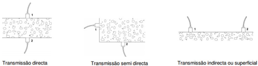
Figura 19 - Ensaio de ultra-sons - métodos de disposição dos transdutores (adaptado de [18])
