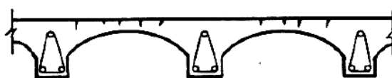
Figura 6 - Fissuras devidas à retracção plástica na lâmina de compressão de uma laje aligeirada [12]
