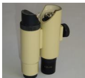
Figura 16 - Lupa de fendas [18]
