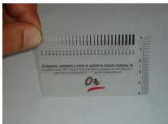
Figura 15 - Comparador de fendas [18]
